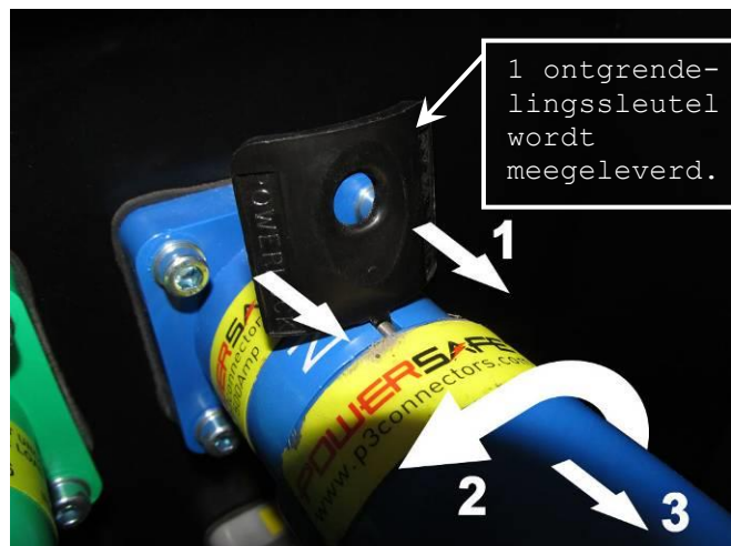
Figuur 26. Het loskoppelen van de Powersafe vermogensconnectoren gebeurt dmv. een ontgrendelingsleutel.
